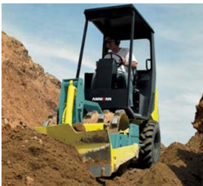
Poste de conduite ouvert
