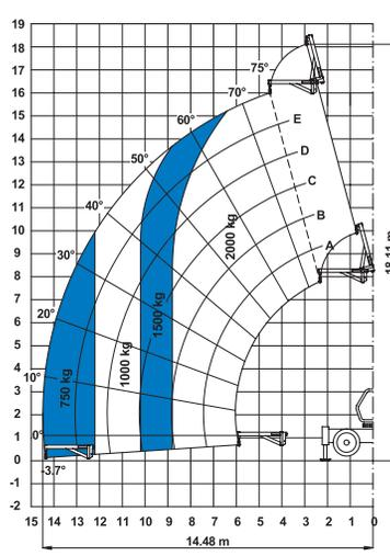
Sur stabilisateurs avec fléchette 4m (hydraulique/mécanique)
