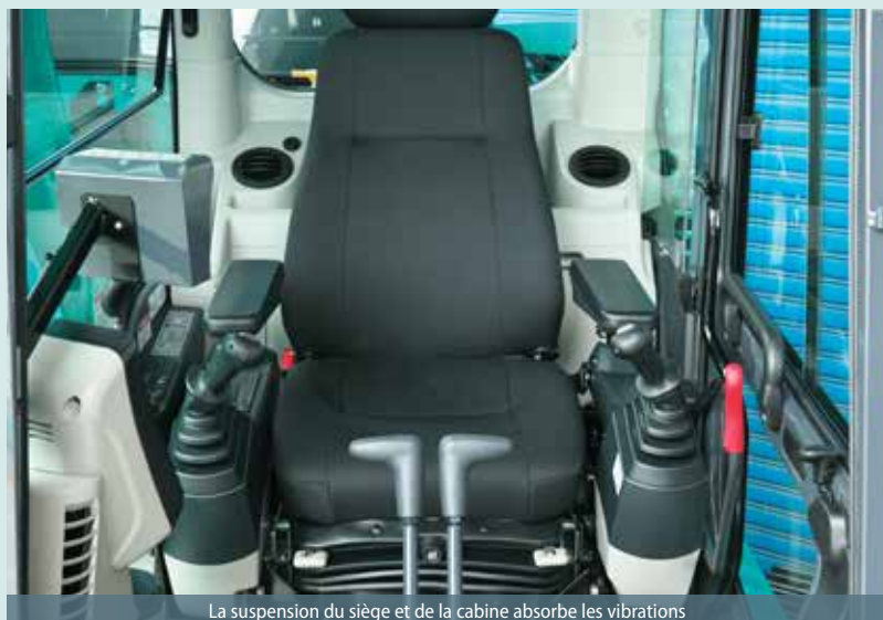
La suspension du siège et de la cabine absorbe les vibrations
