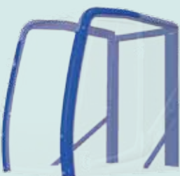
La protection FOPS niveau II est montée de série (conforme ISO10262)
