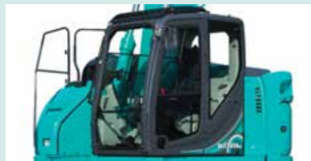
Ergots de fixation des protections antivandalisme de série (contactez votre concessionnaire KOBELCO pour poser des protections antivandalisme ou de pare-brise).
