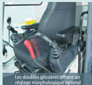
La suspension du siège et de la cabine absorbe les vibrations
