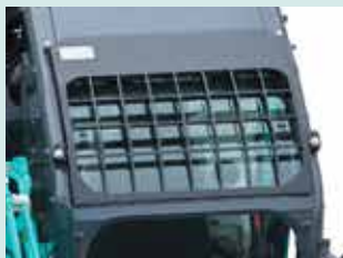
La protection FOPS niveau II est montée de série (conforme ISO10262)
