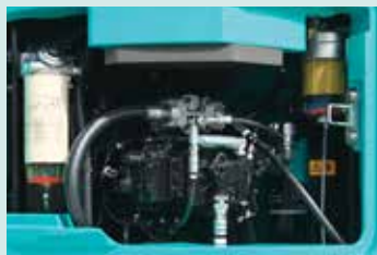
Préfiltre et filtre à carburant avec décanteur d'eau intégré
