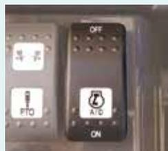
Si les manipulateurs restent en position neutre pendant plus de 4 secondes, le régime moteur passe automatiquement au ralenti pour réduire le bruit, les émissions et la consommation.
