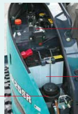
Réservoir hydraulique    Batterie    Réservoir à carburant
